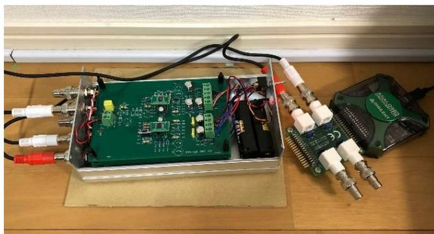
図6 製作したアンプ基板
