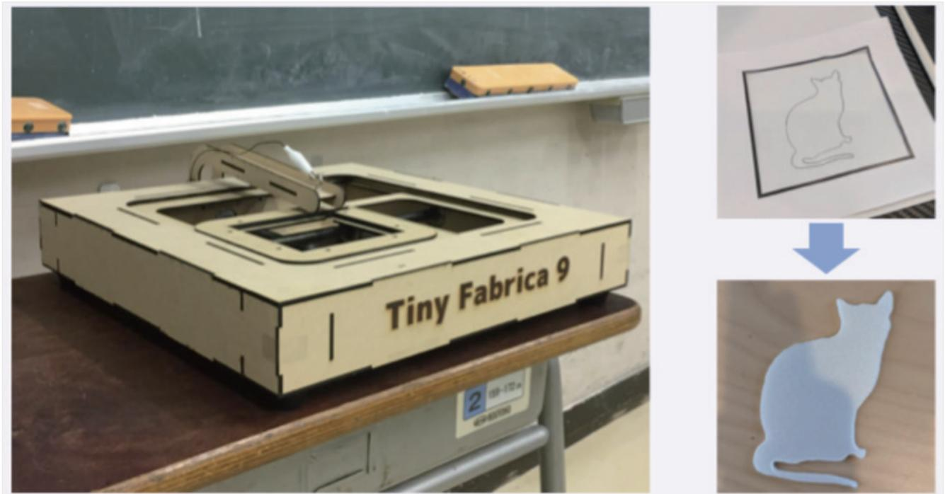
図-1 Tiny Fabrica 9 とスチロールカットの例
