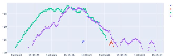
図9 図7の環境において左側のタグをアンテナに向けて矢印の方向へ移動した時の各タグの位相変動
