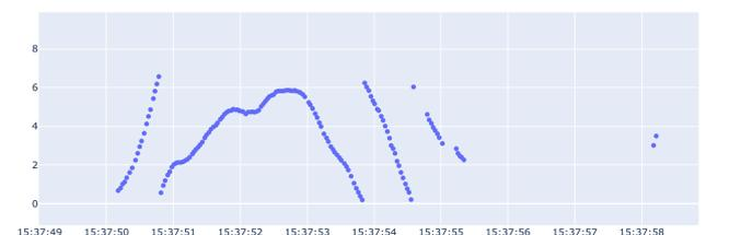
図 6 図 2 の環境において Tag1 から Tag2 方向へ人物が直進した際の人物タグの位相変動の生データ
