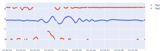
図 5 図 2 の環境において Tag1 から Tag2 方向へ人物が直進した際の人物タグの RSSI 変動の生データ
