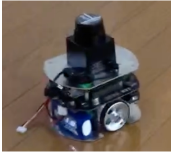
図 3: 本研究で利用するロボット. 小型車輪型ロボット (RT 製 Raspberry Pi Mouse に HOKUYO 製 URG-04LX-UG01 を搭載したロボット) を実験に利用する.
