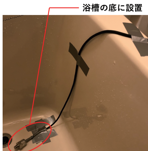
図 3 水圧センサの設置方法
