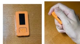
図 12 使用した 3 軸加速度センサーとその持ち方
