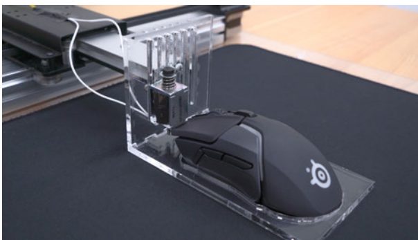
図 3 ソレノイドを用いてクリックの再現をする
