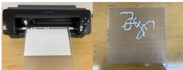
図 4 展開図をカッティングマシンで出力する様子
