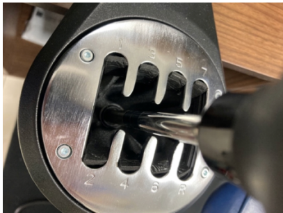
図2 緩衝テープを貼り付けたシフトゲート
