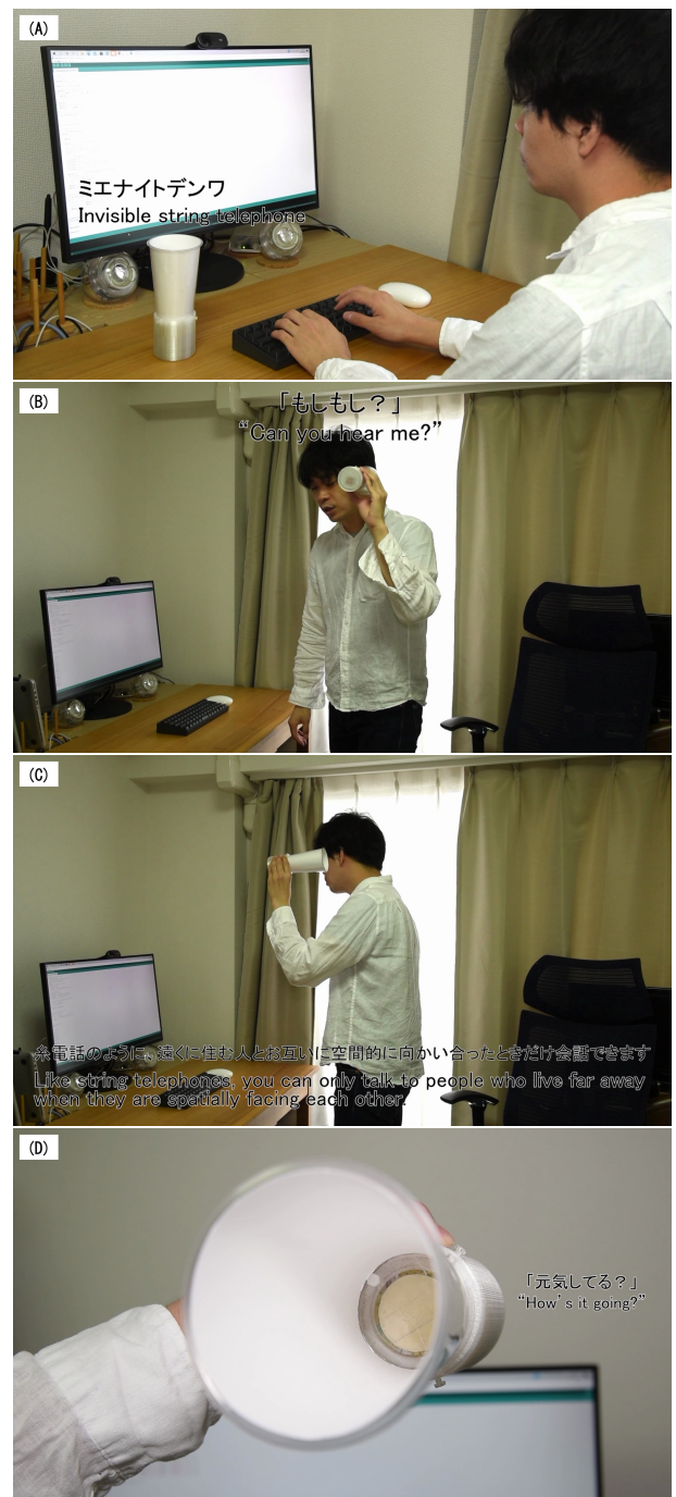
図2 ミエナイトデンワを使用したデモ動画の流れである。シーンは(A)から(D)の順に展開する。(A)机に置かれたミエナイトデンワ。(B)ミエナイトデンワを使って通話するために、相手のいる方向を探す。(C)お互いに空間的に向かい合った状態となり、会話を開始する。(D)コップの底から相手の声が聞こえている。
