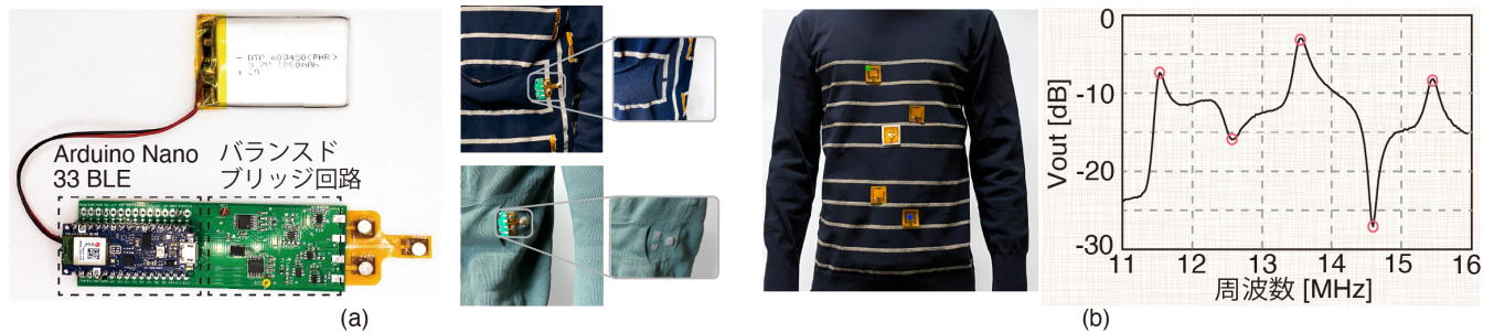
図 6 (a) 計測モジュールのプロトタイプと (b) 5つの異なるセンサコイルの読み取り結果。 Fig. 6 (a) Prototype of measurement module and (b) its readout result of the five different sensor coils.
