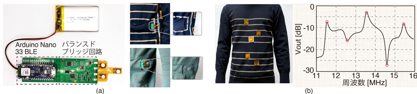
図 6 (a) 計測モジュールのプロトタイプと (b) 5つの異なるセンサコイルの読み取り結果。
