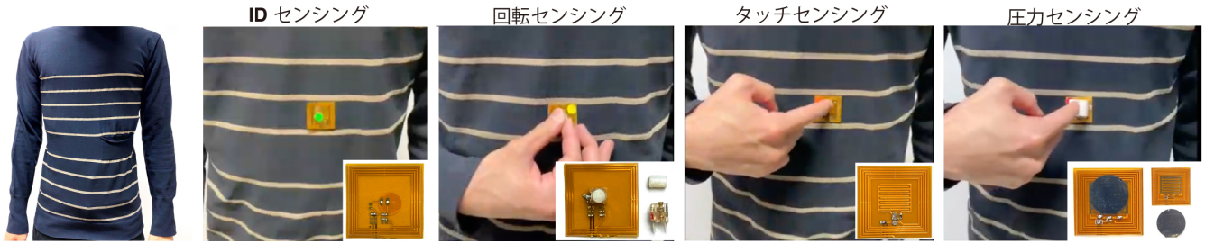
図 1 双子のメアンダコイルの概要.
