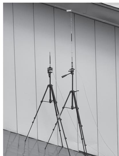
図 7  $1/2 \lambda$  モノポールアンテナ (左) と  $5/8 \lambda$  4 段 C-Load ノンラジアルアンテナ (右)
