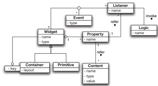
図 1: GUI プログラミングモデル
