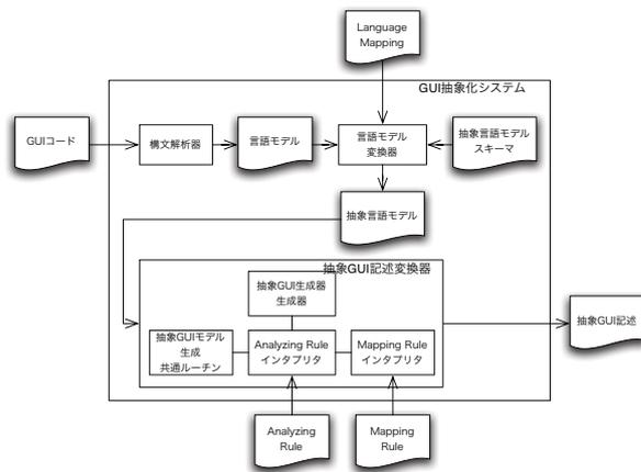
図 5: 抽象 GUI 構築システムの構成
