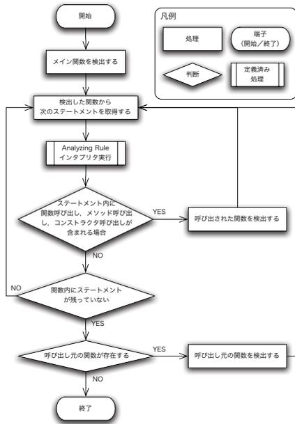
図 7: 抽象 GUI 記述生成共通ルーチンの処理フロー
