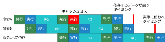
図 11 リプレイの導入による性能低下の要因の例 Fig. 11 An example of performance degradation caused by introducing replay
