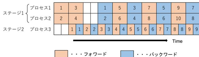
図 2 パイプライン化ハイブリッド並列の処理の概要図
