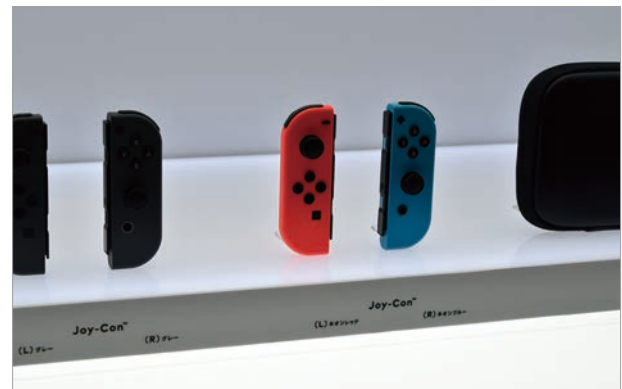
■ 図-9 任天堂Switchの標準コントローラ「Joy-Con」の振動素子としてはこのハプティックリアクタが採用されていた
