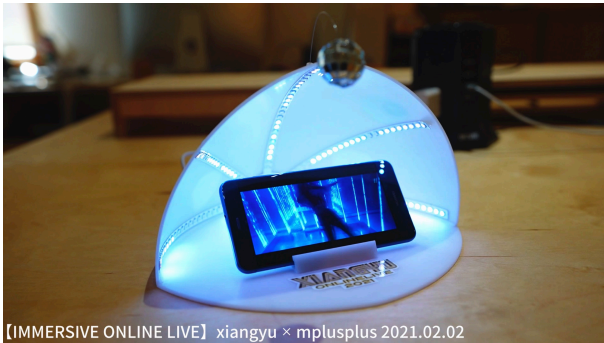
図 4 ライブ配信に同期して点灯する LED 相違の様子
