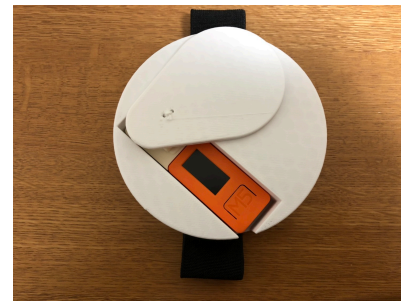
図 7 各種センサ及びアロマストーンを内蔵した状態の AroNap モジュール
