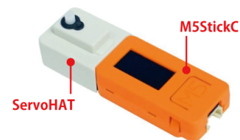
図 4 M5StickC と ServoHAT を接続した様子
