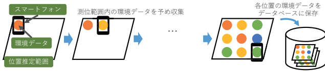
図 2 提案手法の磁気センシングにおける、学習フェーズ Fig. 2 Training phase.
