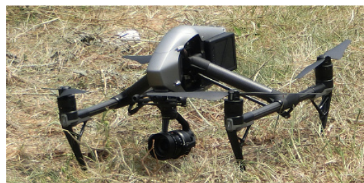
図2 カメラ搭載 UAV (DJI Inspire2)
