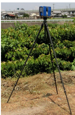
図1 地上型レーザスキャナ (FARO Focus3D)
