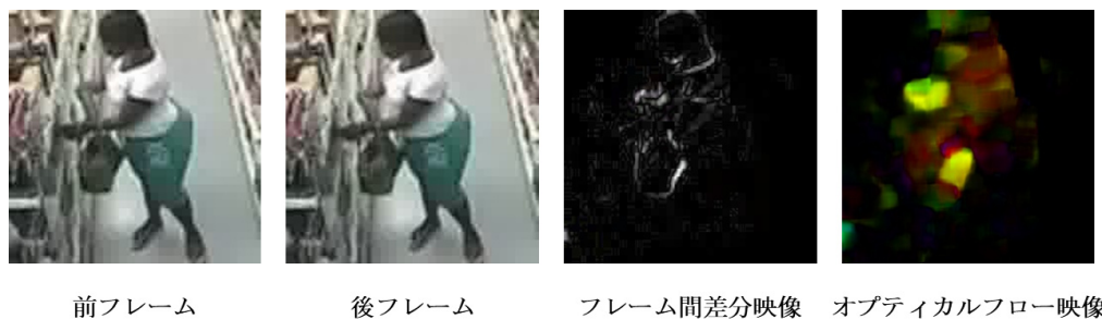
図 3 フレーム間差分映像とオプティカルフロー映像の例
