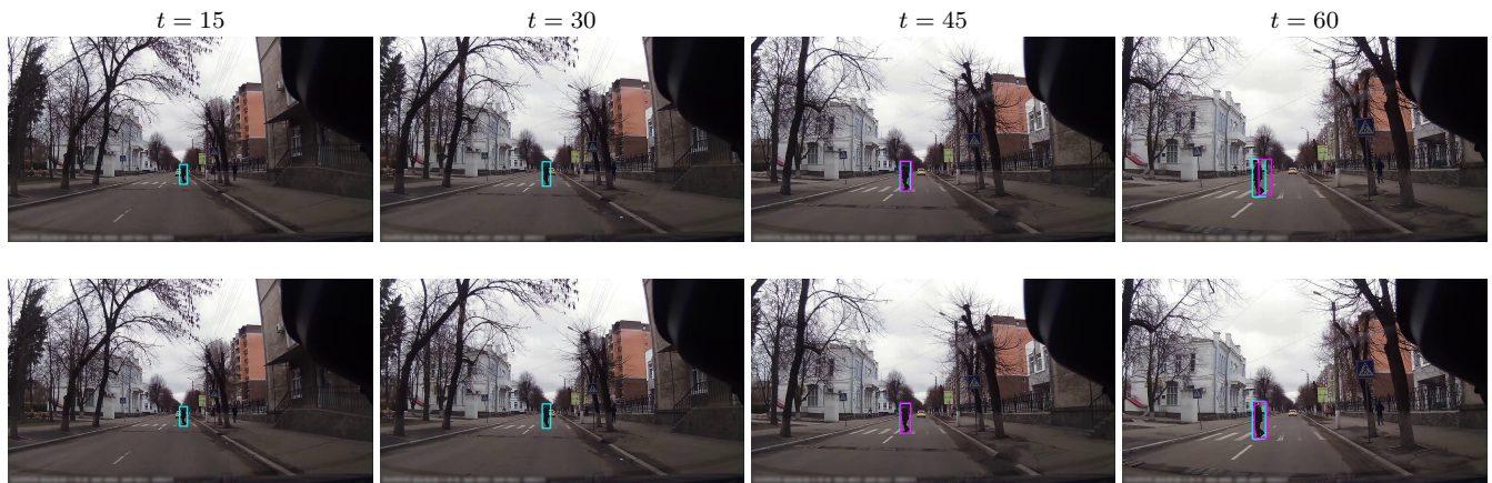
図 4 胸部方向なしモデル（上段）および胸部方向ありモデル（下段）による予測結果。左側 ( t = 15, 30 ) に観測フレーム，右側 ( t = 45, 60 ) に予測フレームを示す。シアンのパウディングボックスが真値，マゼンタのパウディングボックスが予測結果を表す。胸部方向なしモデルは観測から時間が経過するほどパウディングボックスのずれが大きくなっていく。胸部方向ありモデルでは観測から時間が経過してもパウディングボックスのずれは小さい。
