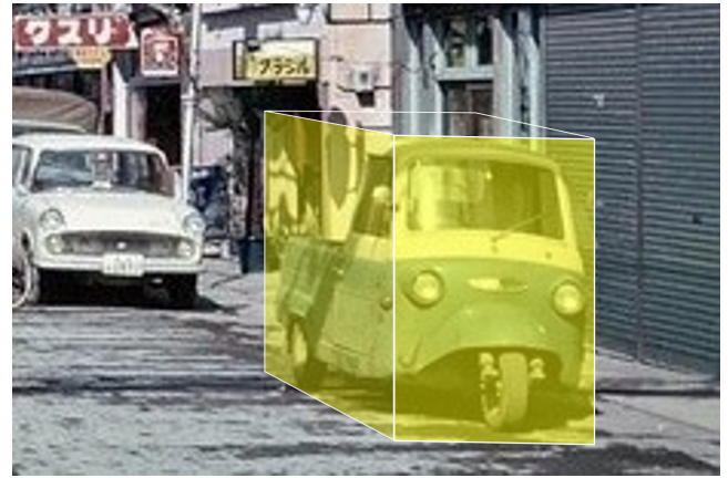
図 4 物体復元のイメージ図. 物体をの形状を直方体に単純化して考えることで, 複雑な形状の物体でも形を保ったまま頑健に復元することができる.
