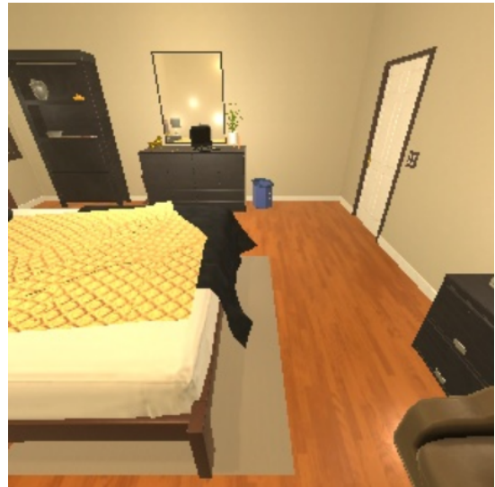
図 3 ALFRED [21] の動作環境である AI2THOR [16] 環境において、エージェントの動作計画が難しい例。エージェントの主観視点画像から動作計画を行う。エージェントは左前方のベッドと右のソファの間を通り抜けて、右前方へと通り抜きたいとする。現地点で一度でも前進操作を行うと、エージェントはベッドフレームに衝突する。右旋回、前進、左旋回、前進と行うことで通り抜けることが出来るが、右旋回の後、2回にわたって前進操作を行うと、ソファに衝突する。
