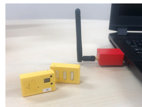
図8 筋電位センサと通信デバイス [32][33]
