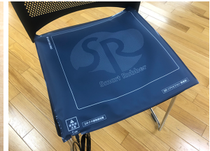
図7 座面圧センサ [31]
