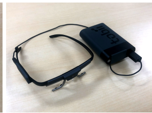
図5 視線・瞳孔径センサ [29] センサ [28]
