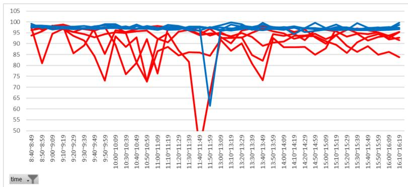
図 32 ネットワーク A とネットワーク B の時間経過に対する TCP 通信の割合の変化の比較
