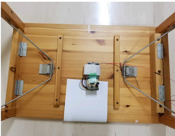
図 2 机に設置された脚部動作計測デバイス
