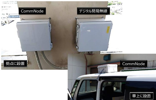
図 2 (b) : CommNode 設置の様子
