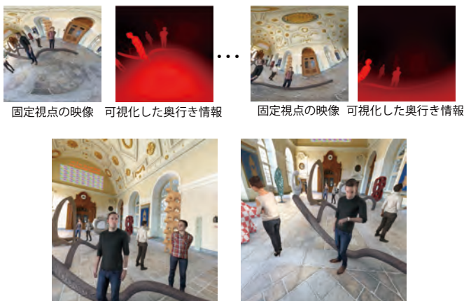
■ 図-2 固定視点の映像と奥行き情報 (上段) を用いて視点内挿により生成した映像 (下段)
