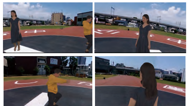
■図-7 ポイントクラウドオブジェクトと360度映像をシーン記述で組み合わせ、ヘッドマウントディスプレイを付けて歩きながら周りを見た映像
