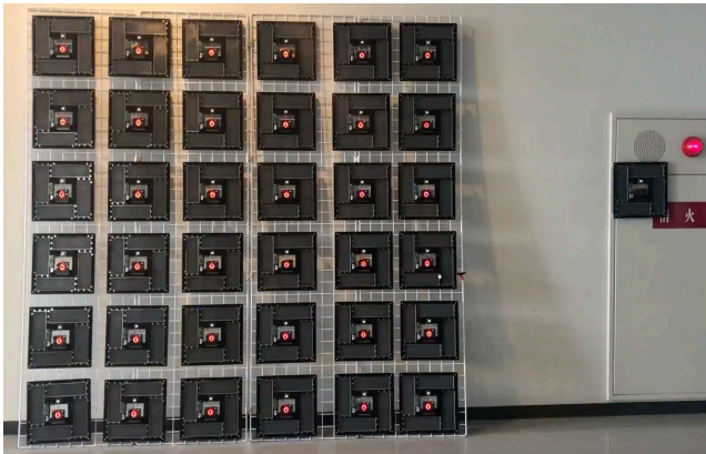
図 7 実装した MicroDeep 実行基盤 (36 台の MD-Board および判定結果表示用の MD-Board)
