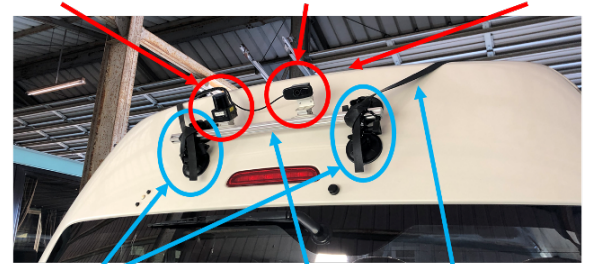
強力吸盤 (大型カメラ固定用) アルミバー ゴムベルト (落下防止用)
