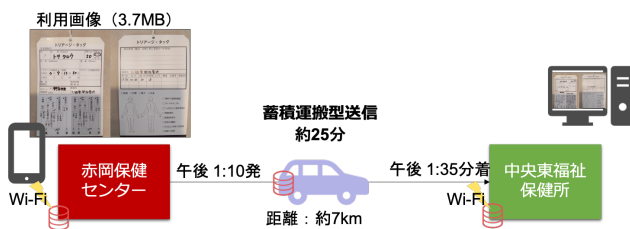
図 11 車両を用いた Delay Tolerant Network によるデータ送信
