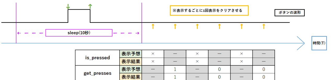
図 7(a) 応用試験「4.ボタンの入力関数を複数呼び時間経過後の状態に影響するかを確認 (sleep 時に入力後確認)」の例として「4.1 ボタンの 1 回押し(3)is_pressed と get_presses を交互に確認」の試験概要と結果
