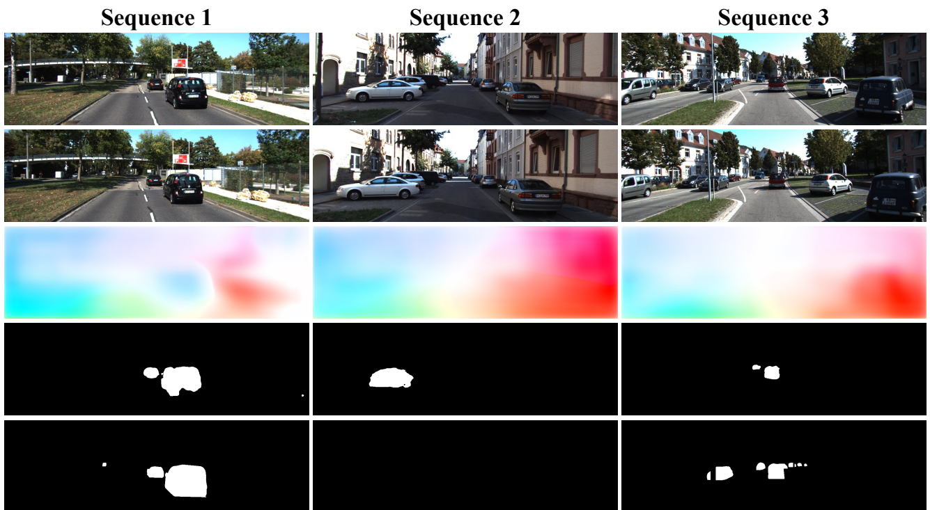
図 6 KITTI-MS のテストデータに対する推定例. 上から順に, 基準フレーム, 参照フレーム, 可視化した推定 Optical Flow, 推定 Motion Mask, 正解 Motion Mask を示す.
