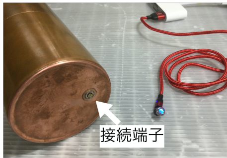
図 4 計測用茶筒の下面および配線実装
