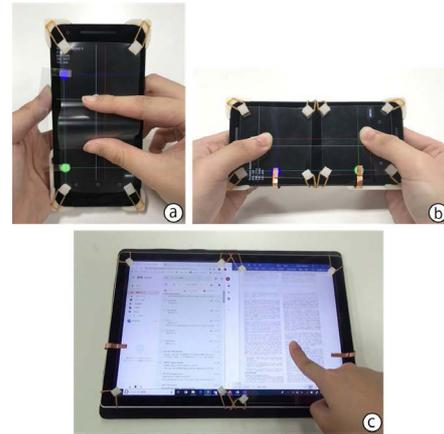
図 10 マルチタッチインタラクション例。(a) 剪断力をともなうピンチイン・アウト、(b) 複数のシートの検出と(c) その利用例
