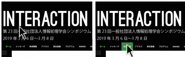
図 1 ナビゲーションバーの例。アイテムにカーソルがのったとき、アイテムの背景がハイライトされる。背景がハイライトされるまで Motor Width の正確な大きさを把握できないが、左右のアイテムの並びからおおよその Motor Width を推測できる。このとき、アイテムのラベルが Visual Width である
