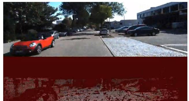
図4 動画における one shot の RGB の frame 画像（上半部分）とこの frame において Lidar によって計測された距離の明暗（256 階調）画像（下半部分）を示す。
