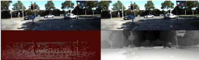
図8 動画における one shot の RGB の frame 画像 (左右上半分) とこの frame において Lidar によって計測された距離の明暗(256 階調)画像 (左下半分) と、動的視差法による距離画像(右下半分) を示す。
