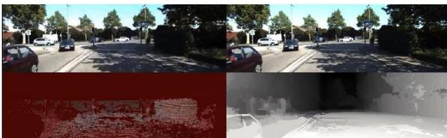
図9 動画における one shot の RGB の frame 画像 (左右上半分) とこの frame において Lidar によって計測された距離の明暗(256 階調)画像 (左下半分) と、動的視差法による距離画像(右下半分) を示す。
