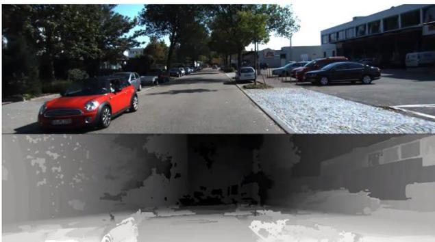
図5 図4に対応する動画における one shot の RGB の frame 画像（上半図）とこの frame において動的視差法によって計測された距離の明暗（256 階調）画像（下半図）を示す。
