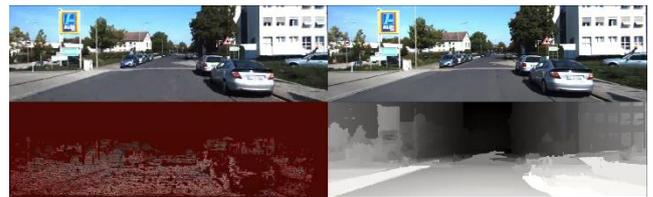
図7 動画における one shot の RGB の frame 画像（左右上半分）とこの frame において Lidar によって計測された距離の明暗（256 階調）画像（左下半分）と、動的視差法による距離画像（右下半分）を示す。
