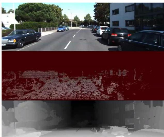
図6 動画における one shot の RGB の frame 画像（上1/3の部分）とこの frame において Lidar によって計測された距離の明暗（256 階調）画像（上から2番目の1/3の部分）を示す。
