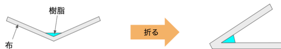
図 1 リントラク加工の模式図. 布の折り目に樹脂を塗り付け (左), 折り曲げた後自然乾燥させる (右)
