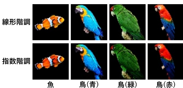
図 6 実験に使用した 4 種類の画像。上段が通常の線形階調の画像、下段が知覚感度補正をした指数階調の画像
