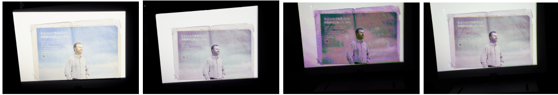
図3 静的環境下における色操作: (a) 白色照明下の見かけ, (b) 基準深度における色操作結果, (c) 深度情報なしの色操作結果, (d) 深度情報ありの色操作結果 Fig.3 Color manipulation in static environment: (a) Uncorrected image, (b) Color manipulation result at reference depth, (c) Color manipulation result without depth information, (d) Color manipulation result with depth information
