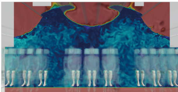
図-2 航空機内の換気評価（赤：汚染空気，青：清浄空気）。換気後30秒後と100秒後を可視化 (協力：日本航空，豊橋技科大，東工大)
