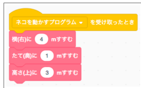
図 4 キャラクターが図 3 の風船の位置まで移動するプログラム例とができない児童もいた。
