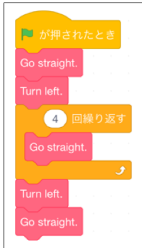
図 5 ロボットが宝物にたどり着くプログラム例 (実践事例 2)
