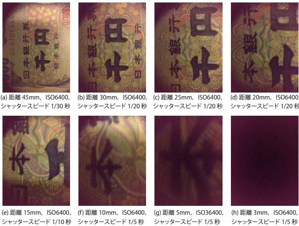
図 1 ピンホールを貼付した状態で千円札を撮影した。フラッシュライトはつけていない。ISO 感度はかなり上げているが、全体的に暗い。ピンホールをつけることで明度が落ちることが分かる。
