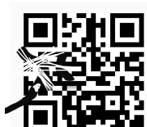
図 10 正規の QR コード (誤り訂正ブロックに集中するように白と黒の混在した汚れを復号できる限界まで付加)
