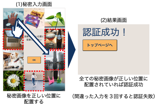
図 2 PPA の認証手順。Drag&Drop 操作で秘密画像を正しい位置に配置し直し、その結果が正しければ認証成功。
