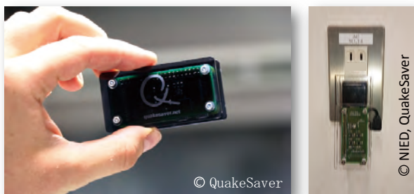
■ 図-3 エッジコンピューティング技術を用いた超小型地震計。コンセントに差し込むだけで観測ができる。WiFiを用いて、クラウドにデータを上げ、世界中どこからでも利用できる。防災科研とQuakeSaver社とが共同開発している。
