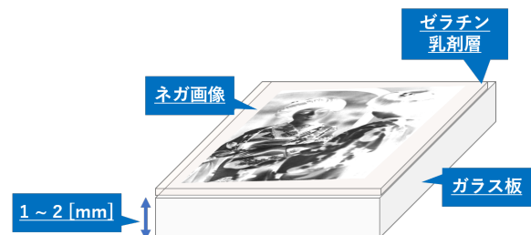
図1 写真乾板の構造
