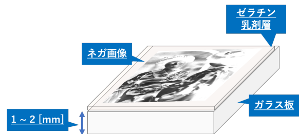
図1 写真乾板の構造
